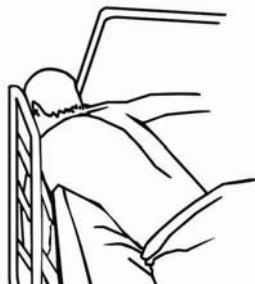
Atascamiento entre el extremo de la baranda y el borde lateral de la cabecera o los pies de la cama
