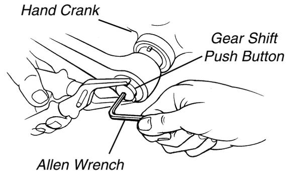
**FIGURE 7 - MOUNTAIN DRIVE OPTION - ADJUSTING GEAR SHIFT PUSH BUTTON**
