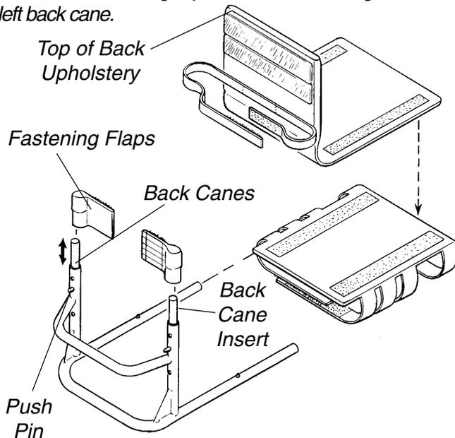
**FIGURE 1 - BACK HEIGHT ADJUSTMENT
